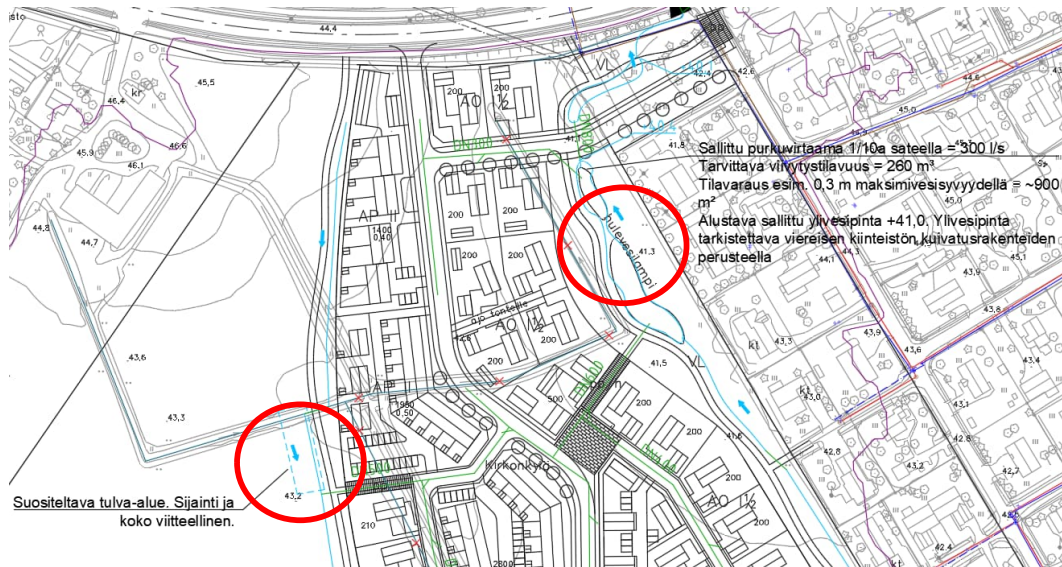
Kuva 12. Kaava-alueen pohjoisosan suunnitellut hulevesien hallintarakenteet
